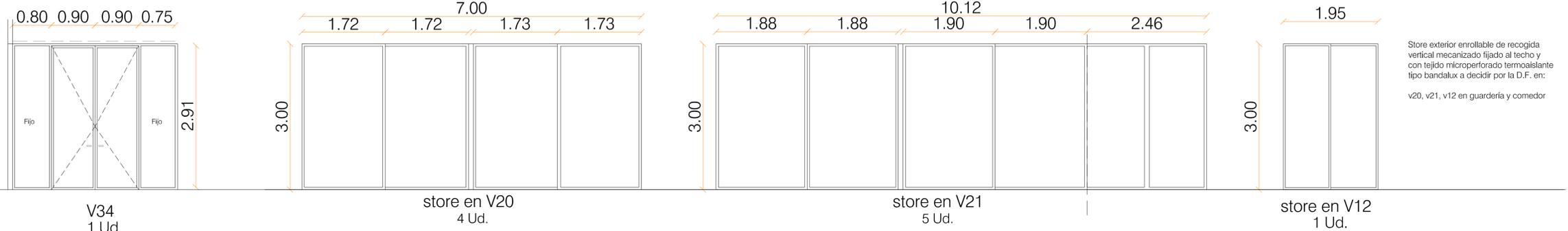
Store exterior enrollable de recogida vertical mecanizado fijado al techo y con tejido microperforado termoaislante tipo bandalux a decidir por la D.F. en:
